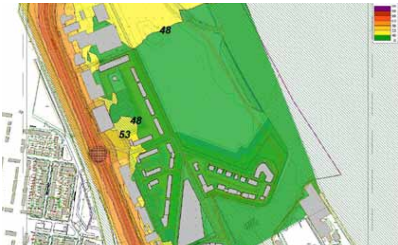
48, 53, 58 en 63 dB geluidscontouren eerste verdieping (4,5 m hoogte)
